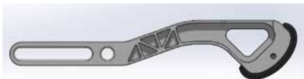
Рис. 5. Модель прототипу ноги робота, вид збоку
